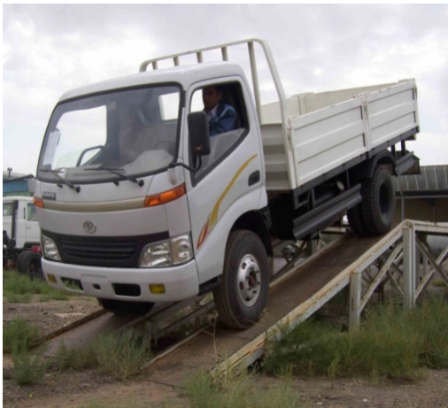
شکل ۹ استفاده از سطح شیب‌دار در اندازه‌گیری نیروی ترمزی هر یک از چرخ‌ها برای تعیین خطای نیروی ترمزی
