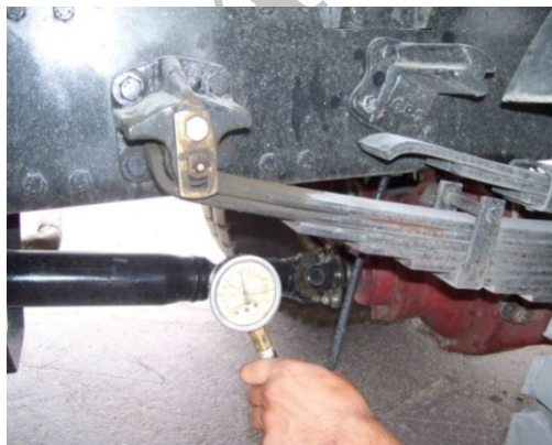
شکل ۱۰ اندازه‌گیری فشار هیدرولیکی در مدار سیستم ترمز برای تعیین خطای نیروی ترمزی
