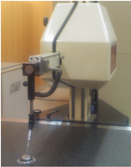
شکل ۱۳ بررسی مسیر خط جوش توسط دستگاه CMM
