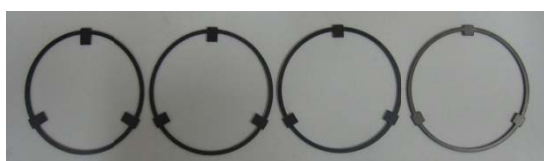
شکل ۷ فیکسچر - فاصله‌اندازهای ساخته شده برای نسبت‌های کشش مختلف
