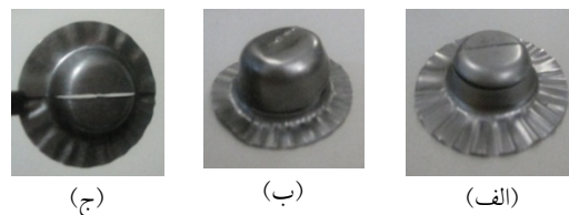
شکل ۱۲ انواع پارگی در شکل‌دهی هیدرومکانیکی لوح‌های ترکیبی: (الف) شعاع سر سنبه در بخش نازک‌تر لوح؛ (ب) شعاع رینگ کشش در بخش نازک‌تر لوح؛ (ج) ناحیه‌ی جوش
