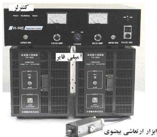
شکل ۲ ابزار ارتعاش بیضوی به همراه سیستم کنترل آن
