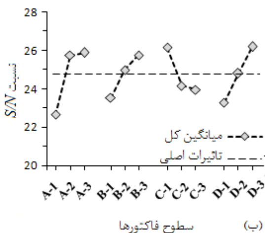
شکل ۱۲ تأثیر اصلی فاکتورها بر بیشترین نسبت نازک‌شدگی در ناحیه‌ی بحرانی D (الف - قطعه‌کار از جنس مس خالص، ب - قطعه‌کار از جنس فولاد St14)
