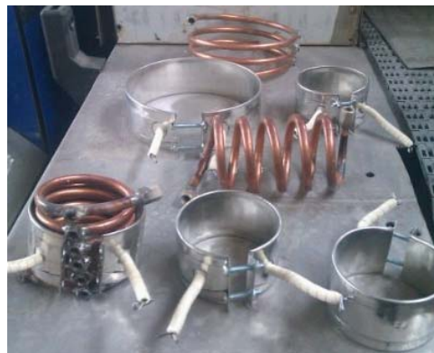
شکل ۴ لوله های مارپیچی و المنت های الکتریکی حلقوی مورد استفاده
