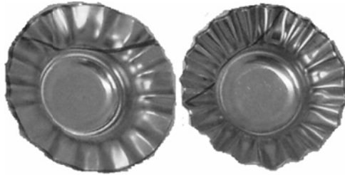
شکل ۵ دو نمونه کشش عمیق با تعداد و ارتفاع چین خوردگی مختلف
