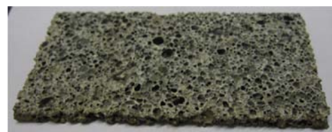
شکل ۳ ورق فوم حفره‌بسته آلومینیم وایرکات شده
