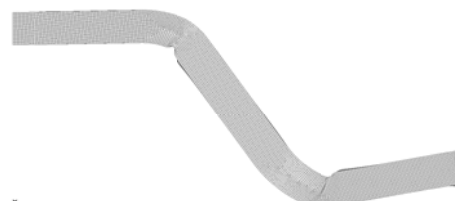
شکل ۱۷ مدل دقیق تغییر شکل یافته برای مقطع مربعی
