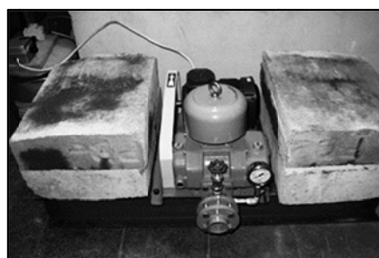
شکل ۸ کمپرسور سه‌باله‌ای به همراه فنداسیون تعبیه شده
