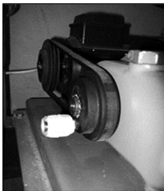
شکل ۱۰ کمپرسور نابالانس شده
