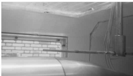
شکل ۸. نمایی از نحوه قرار گرفتن پراب پنج حفره پشت برجک در داخل اتاق آزمون
