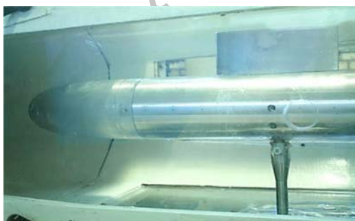
شکل ۴ نحوه قرارگیری مدل زیردریایی به همراه برجک داخل اتاق آزمون تونل باد
