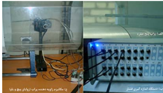
شکل ۶ تجهیزات مورد استفاده در کالیبراسیون پراب پنج حفره الف) پراب پنج حفره، ب) دستگاه اندازه‌گیری فشار (مبدل فشار ۱۵ کاناله) و ج) مکانیزم زاویه‌دهنده پراب
