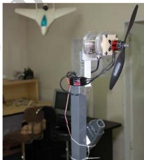
شکل ۵ دستگاه اندازه‌گیری نیروی پیش‌ران ساخته شده در آزمایشگاه ریزپهپاد
