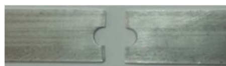
شکل ۱۰ قطعه آزمایش سوم بعد از شکست
