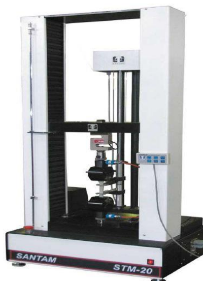
شکل ۶ دستگاه اندازه‌گیری خواص مکانیکی (کششی) لاستیک‌های پخت شده
