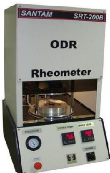
شکل ۵ دستگاه اندازه‌گیری خواص پخت
