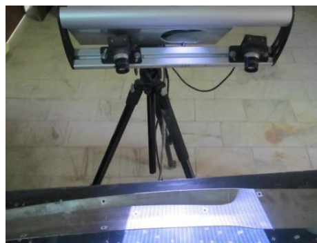
شکل ۱۳ اسکتر نوری برای اندازه‌گیری عیوب پیچش و انحنای طولی
