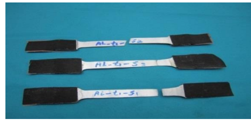
شکل ۲ نمونه‌های تست کشش برای تعیین مشخصات مکانیکی ورق آلومینیومی
