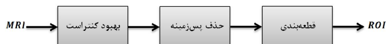
شکل (۲): فرآیند پیش پردازش و استخراج ROI از هر تصویر MR سینه
