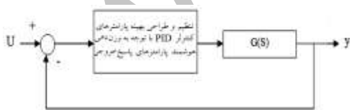
شکل (۱): بلوک دیاگرام کنترلر PID با استفاده از الگوریتم ازدحام ذرات و نلدرمید (PSO-NM)
