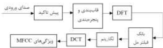
شکل (۴): بلوک دیاگرام محاسبه MFCC
