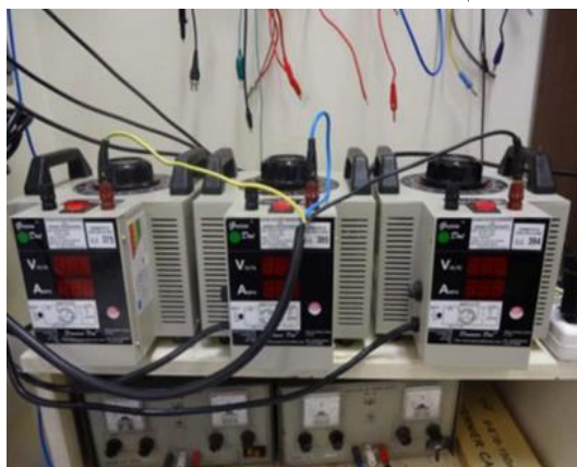
شکل (۱۰): تنظیم کننده ولتاژهای ورودی (واریاک)
