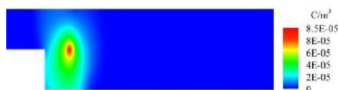
شکل ۹- توزیع چگالی بار الکتریکی ( a=6\text{cm} )، V_0=18\text{kV}
