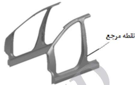
شکل ۲۴- نقطه مرجع بر روی ستون میانی برای اندازه‌گیری پارامترها
