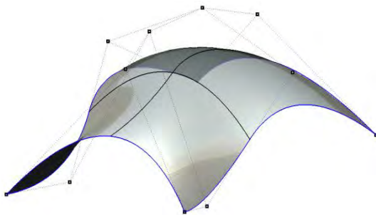
شکل ۲- شبکه نقاط کنترلی و سطح نریز مربوط به آن با توابع پایه درجه دو
