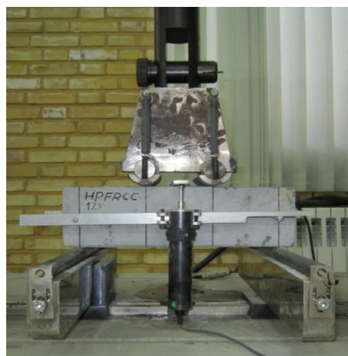
شکل ۴- هندسه نمونه‌ها و چیدمان آزمایش مقاومت خمشی
