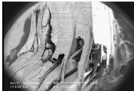
شکل ۶- شکست‌های ایجاد شده در نمونه بازالت خالص
