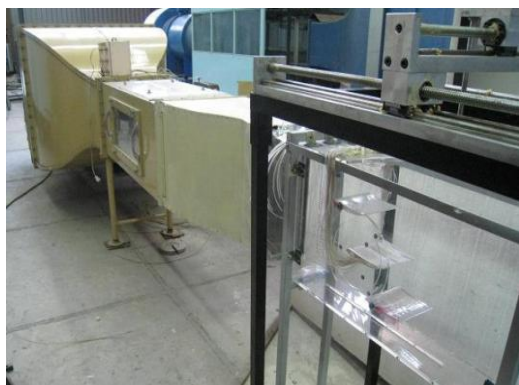
شکل ۱- تونل باد نصب شده در آزمایشگاه آیرودینامیک
