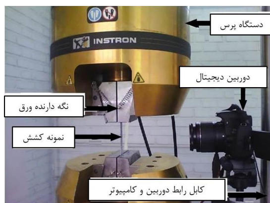
شکل ۳- طرح آزمون کشش تک‌محوری و موقعیت اجزاء
