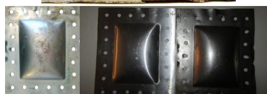
شکل ۳- نمونه‌هایی از تغییر شکل ورق مستطیلی تحت بارگذاری هیدرودینامیکی
