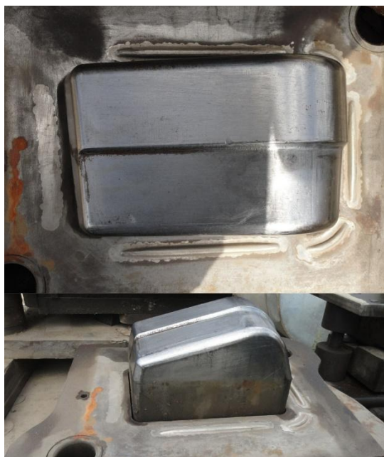
شکل ۱۱- قالب ساخته شده گل سپر نیسان
