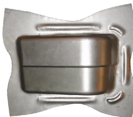
شکل ۱۲- کانتور تنش قطعه گل سپر نیشان و نمونه عملی تولید شده
