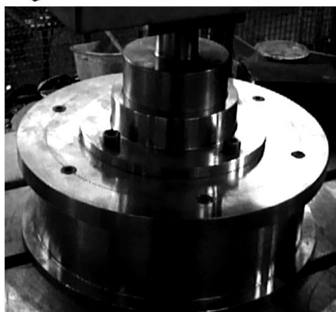
شکل ۵- شماتیک و نمونه قالب آزمایش کشش خارج از
