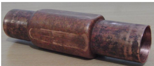
شکل ۱۱ - قطعه شکل داده شده بدون پارگی در پله اول با استفاده از مسیر فشار استفاده شده در آزمایشگاه
