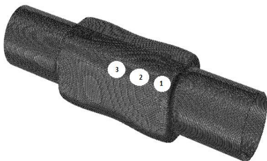
شکل ۱۲ - قطعه شکل داده شده با استفاده از مسیر فشار شکل ۱۰ به دست آمده از شبیه سازی
