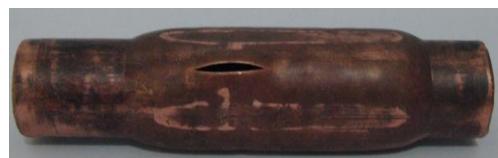
شکل ۹ - قطعه شکل داده شده در مرحله بالج در فشار ۱۷MPa به دست آمده از آزمایش تجربی
