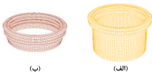
شکل ۲۶- اثر سرعت برخورد بر نحوه‌ی فروریزش پوسته‌های برنجی تحت بارگذاری محوری الف) ۵ متر بر ثانیه و ب) ۱۰ متر بر ثانیه
