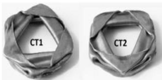
شکل ۴- فروریزش نهایی پوسته‌های استوانه‌ای برنجی
