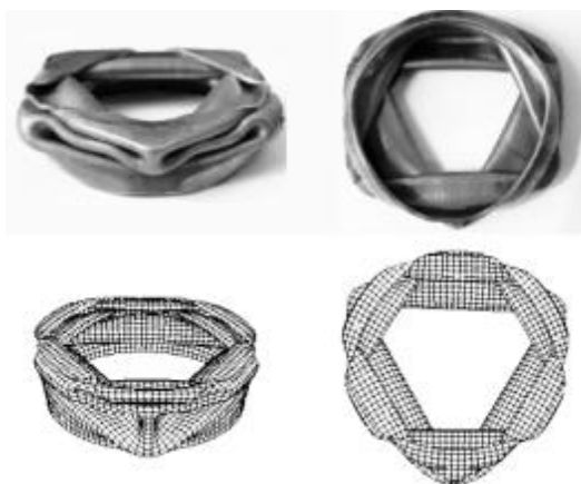
شکل ۸- مقایسه مد فروریزش بدست آمده در نتایج عددی و آزمایشگاهی
