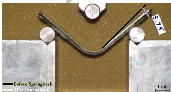
شکل ۳- اندازه‌گیری مقدار زاویه بازگشت فنی ورق
