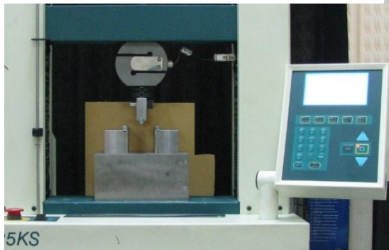
شکل ۲- روش اجرایی آزمایش خم‌کاری سه‌نقطه
