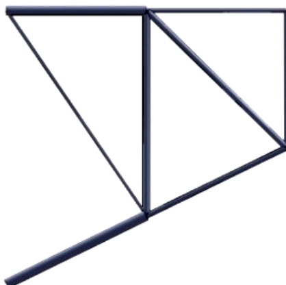
شکل ۳ - طرح بهینه جهت افزایش اختلاف دو فرکانس اول
