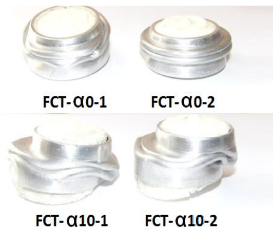
شکل ۹- فروریزش نهایی پوسته‌های مخروطی با فوم تحت بارگذاری محوری و مایل
