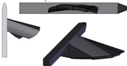
شکل ۵- سه نما از طرح مفهومی پهباد دارای مکانیزم RTM
