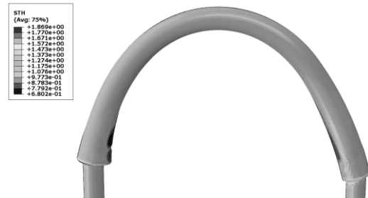
شکل ۱۴- شکل هندسی و کانتور توزیع ضخامت برای مسیر فشار ۲ شکل ۱۳
