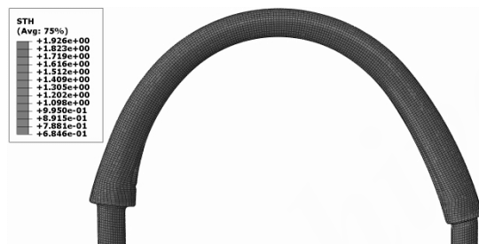
شکل ۱۲- قطعه شکل داده شده با استفاده از مسیر فشار شکل ۱۰ به دست آمده از شبیه سازی
