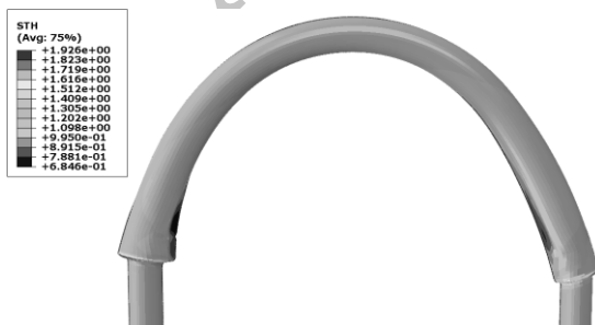
شکل ۱۸- شکل هندسی و کانتور توزیع ضخامت برای مسیر فشار ۲ شکل ۱۷
