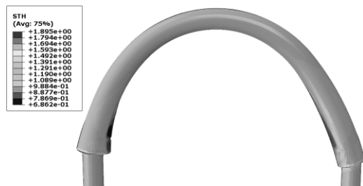
شکل ۱۶- شکل هندسی و کانتور توزیع ضخامت برای مسیر فشار ۲ شکل ۱۵
