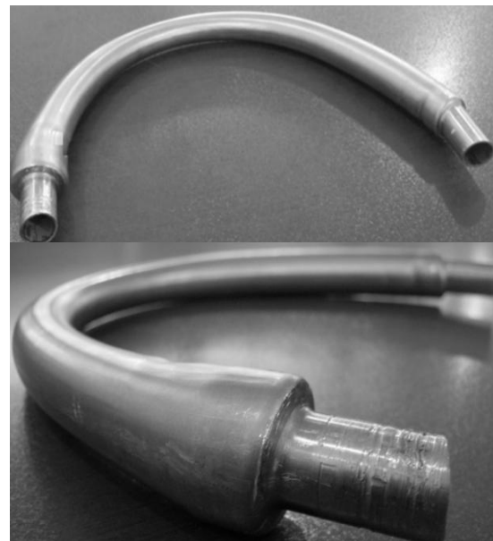
شکل ۱۱- قطعه شکل داده شده بدون پارگی با استفاده از مسیر فشار استفاده شده در آزمایشگاه
