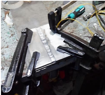
شکل ۲- شرایط و قیدوبندهای جوش کاری
