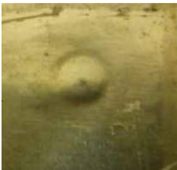
شکل ۱۰- نمای زیرین ورق پایینی با صفحه پش‌تیبیان Al1100
