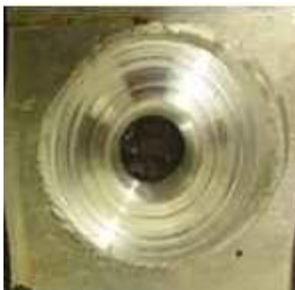
شکل ۱۳- تصویر اتصال با سرعت دورانی ۸۰۰ دور در دقیقه
