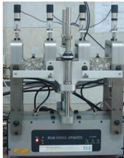
شکل ۳. نمای کلی دستگاه آزمایش خستگی تیرچه خمشی
