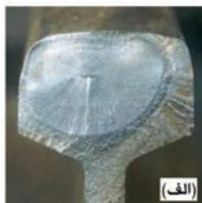
شکل ۱: (الف) ترک عرضی پیش رونده با منشأ داخلی. (ب) ترک سطح بیرونی قارچ به فاصله تقریبی ۱۵ میلیمتر از سطح غلتش ریل.
