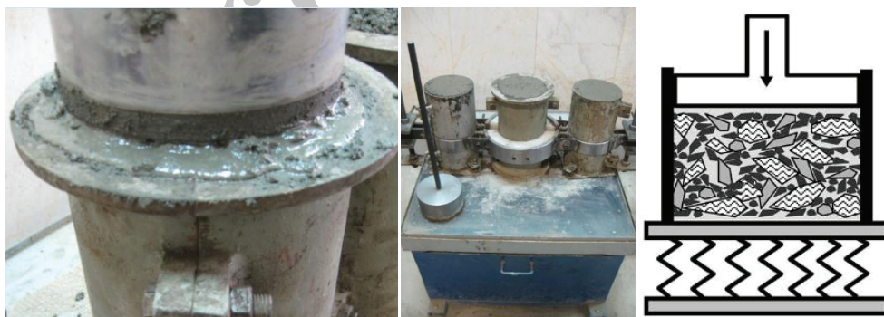
شکل ۳. ساخت و تراکم نمونه استوانه ای بتن غلتکی توسط میز لرزان و سربار
