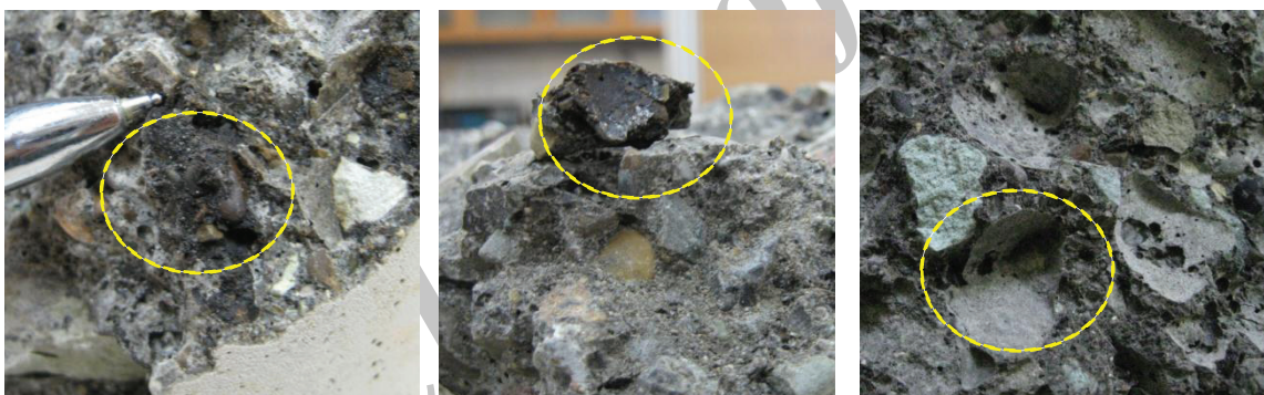
شکل ۱۰. نمونه‌هایی از انتقال ترک به دور سنگدانه‌های خرده آسفالت بازیافتی در مخلوط بتن غلتکی
