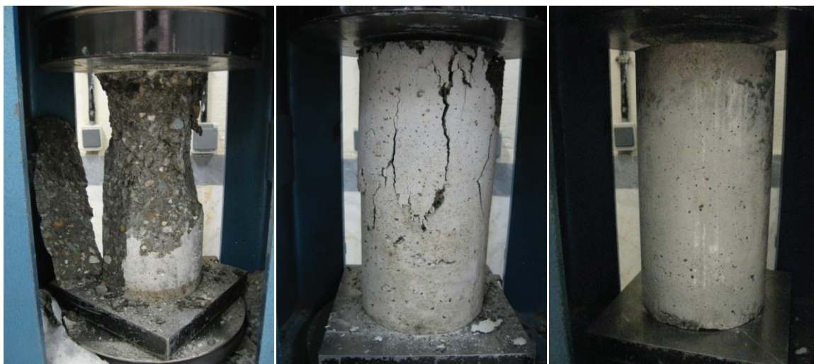
شکل ۶. آزمایش مقاومت فشاری تک محوری
