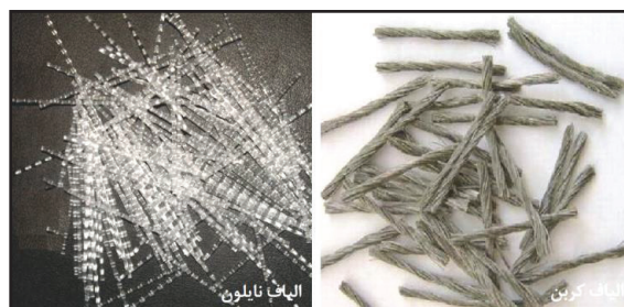
شکل ۱. تصاویر الیاف کربن و نایلون
