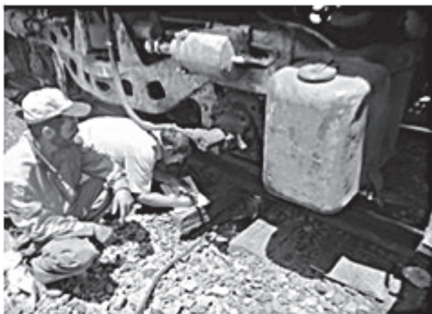
شکل ۶. آزمایش PLT بر روی (الف) بالاست قبل از زیرکوبی، (ب) بستر خط بالاستی
