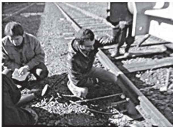
شکل ۶. آزمایش PLT بر روی (الف) بالاست قبل از زیرکوبی، (ب) بستر خط بالاستی
