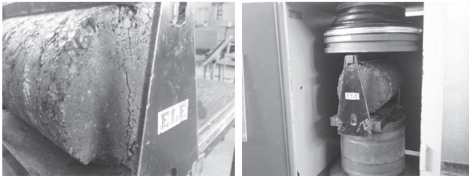
شکل ۳. وضعیت نمونه قبل و بعد از آزمایش مقاومت کششی غیرمستقیم
