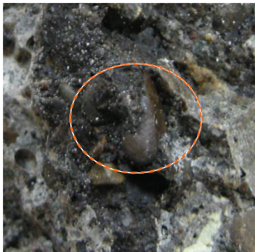
شکل ۷. نمونه هایی از انتقال ترک به دور سنگدانه های خرده آسفالت بازیافتی در مخلوط بتن غلتکی
