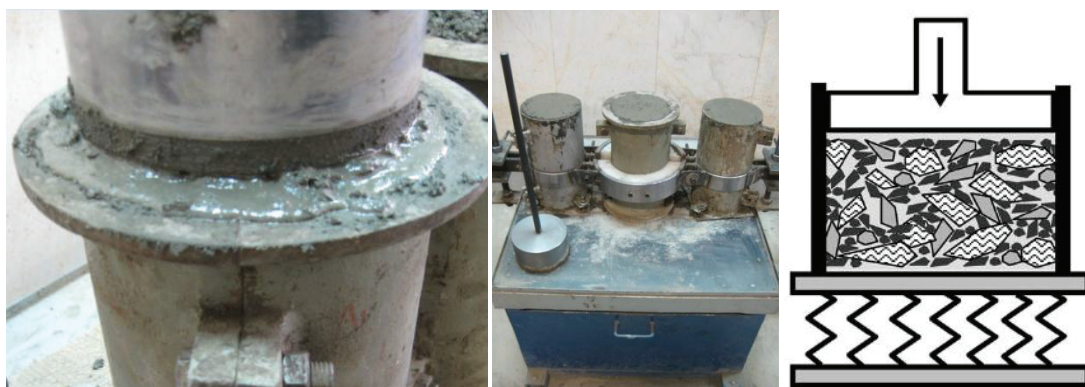
شکل ۳. ساخت و تراکم نمونه استوانه ای بتن غلتکی توسط میز لرزان و سربر
