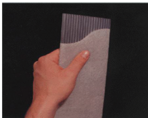
شکل ۲. نمای مقطع عرضی زهکش قائم پیش ساخته
