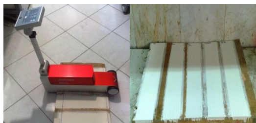
الف: نمونه های تهیه شده برای انجام آزمایش بازتابندگی ب: نحوه قرار گیری نمونه در دستگاه سنجنش بازتاب نور
