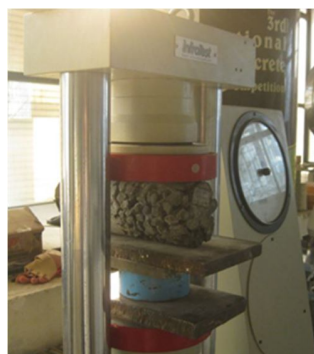
شکل ۵. الف) طریقه قرارگیری نمونه استوانه‌ای در آزمایش مقاومت کششی. ب) نحوه قرارگیری نمونه تیری شکل در دستگاه آزمایش مقاومت خمشی تک نقطه‌ای.
