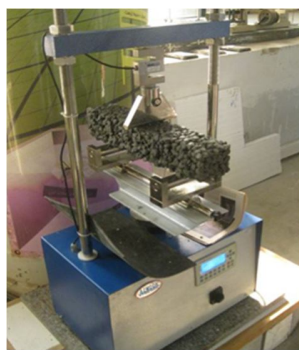
شکل ۵. الف) طریقه قرارگیری نمونه استوانه‌ای در آزمایش مقاومت کششی. ب) نحوه قرارگیری نمونه تیری شکل در دستگاه آزمایش مقاومت خمشی تک نقطه‌ای.
