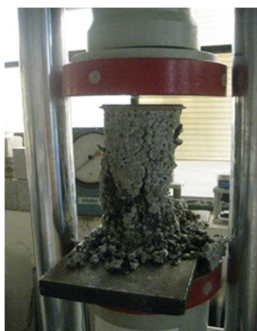
شکل ۴. (الف) نمونه‌های تیری شکل آزمایش مقاومت خمشی. (ب) نمونه استوانه‌ای شکسته شده در آزمایش مقاومت فشاری.
