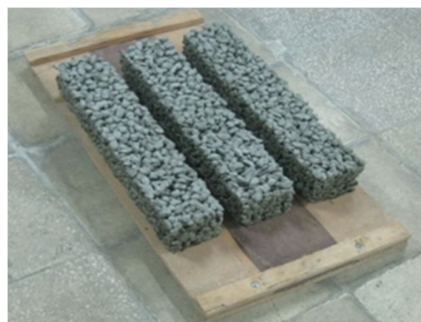
شکل ۴. (الف) نمونه‌های تیری شکل آزمایش مقاومت خمشی. (ب) نمونه استوانه‌ای شکسته شده در آزمایش مقاومت فشاری.
