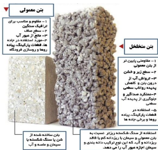
شکل ۱. مقایسه بتن معمولی و متخلخل
