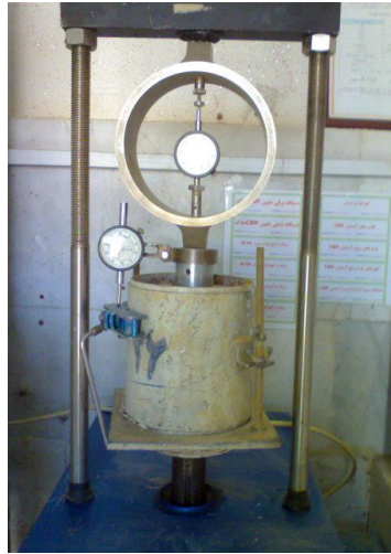
شکل ۷. انجام آزمون نسبت باربری کالیفرنیا در حالت خشک بر روی نمونه‌های مورد مطالعه
