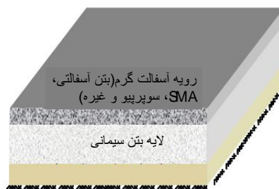
شکل ۱. ساختار روسازی ترکیبی با رویه آسفالتی
